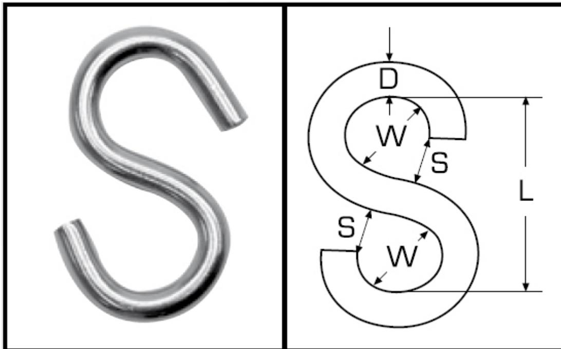
Materialstärke [D] Ø 5,0 mm Innenlänge [L] ca. 40 mm Innenweite [W] ca. 15 mm Weite [S] ca. 7 mm
